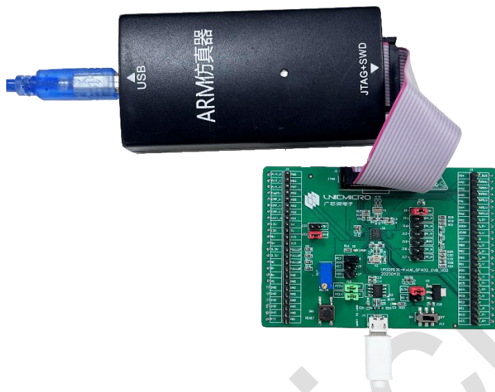
图 2-2: JTAG 仿真调试接线示意图
